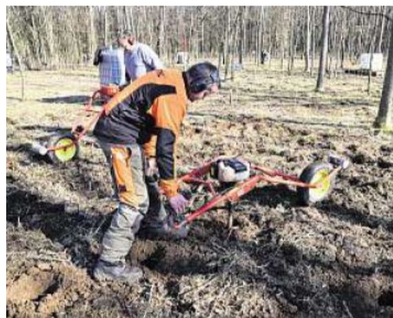
Mit dem Pflanzfuchs bohren die Helfer der Waldkörperschaft Schnackenerth die Löcher für die 2165 Setzlinge.
